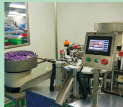
Enplus spike assembly 喂食塑料针组装。
