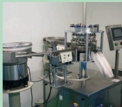
Spin luer lock assembly 旋转鲁尔组装。
