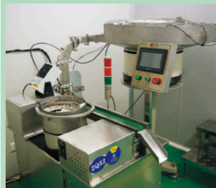
Roller clamp assembly 滚轮调节器组装。
