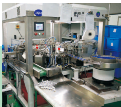
6 parts drip chamber assembly 6个零件滴液室组件。
